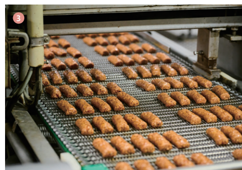
①包装されたモーニングサブを検品。機械での検査に加え、必ず人の目でも確かめる。②10℃以下を保った状態で細びき肉とあらびき肉、香辛料などを混ぜ合わせ、粘りを確認する。小さなハンバーグ状の形を維持するため加熱されるまで低温を維持しながら作業が進められる。③成型されたモーニングサブが規則正しく並んでベルトコンベアで運ばれる。
