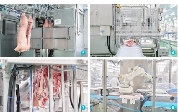
5 枝肉を左右3等分する機械、大分割装置。6 道南工場のみ設置されているモモ用除骨ロボット、ハムダス。7 ワンダス装置とハムダスは道南工場のみ設置。8 自動袋詰め機械のロゴローダー。
