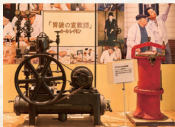
原料肉や製品の保管に必要なアンモニアを使った冷凍機
