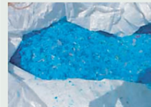
廃プラスチック(破碎・洗浄後)
