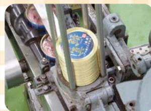
手詰めした後に調味液を充填し、巻締機(シーマー)にて缶胴・缶蓋を密封(二重巻締)します。
