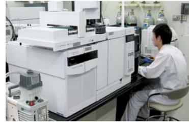
トランス脂肪酸・コレステロールを測定する「ガスクロマトグラフ」
