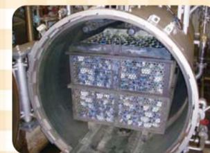
蒸気式殺菌機にて高温で加圧加熱・殺菌し骨までやわらかく調理します。
